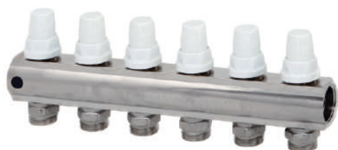
MS sabirnik FF sa ventilima sa termostatskom opcijom art. 1001, "Icma", povratni vod Razmak između priključaka 50 mm Priključak: Spoljni navoj eurokonus 3/4" Izbor aktuatora sa navojem 28x1,5
